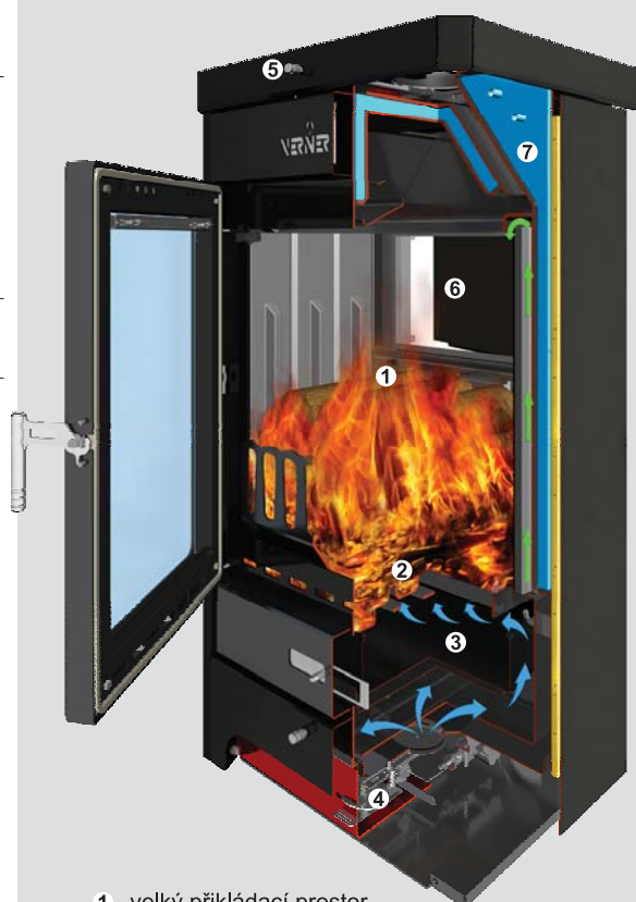
Řez interiérovým kotlem VERNER 13/10 a 13/10.1
